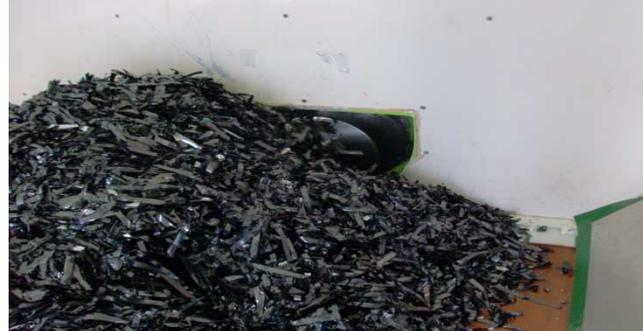
La benne de 5 tonnes est équipée d'une vis sans fin qui permet, pour encore plus de sécurité, de mélanger les documents broyés entre eux.
