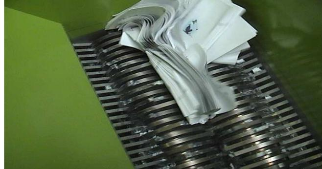
**Le broyeur** est équipé de couteaux de 12 mm, qui selon les normes EN 15713 : 2009 est un déchiquetage de classe 4.
