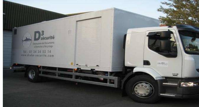
**Le camion** est un châssis Renault, de catégorie 19 tonnes, équipé d'un broyeur industriel de marque Axo Shredders (Nouvelle Zélande) pouvant broyer jusqu'à 2,4 tonnes en une heure, grâce à une technologie nouvelle de couteaux.
